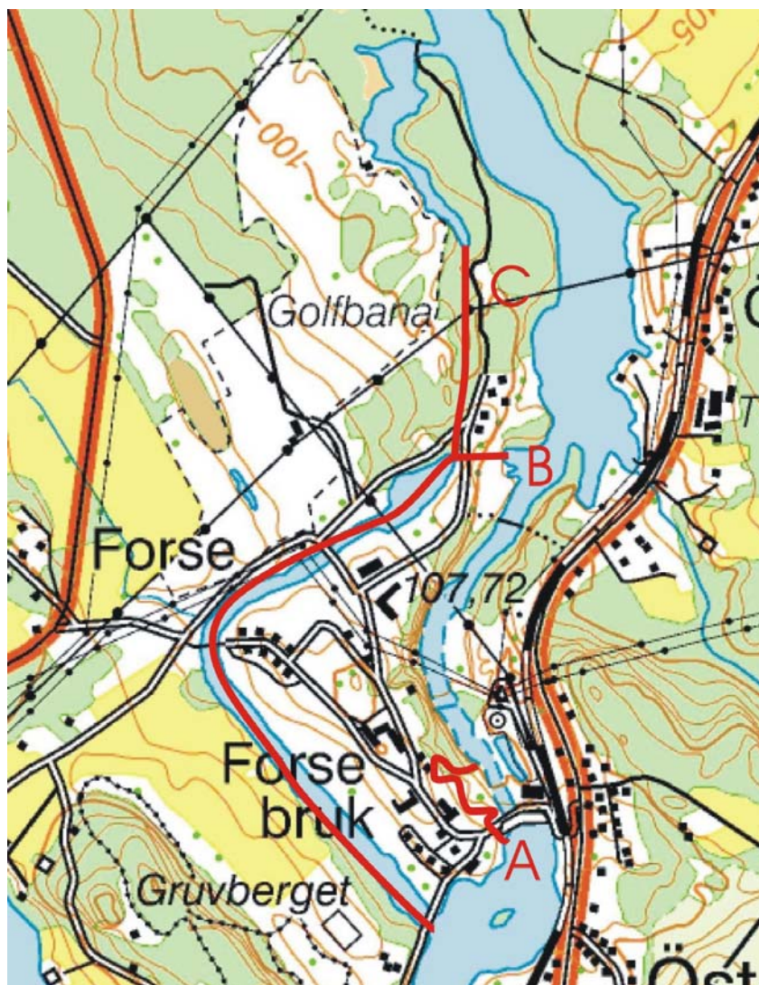
Figur 44. Forse kraftverksdam med de tre alternativen för att skapa fiskvandring förbi kraftverksdammen.
