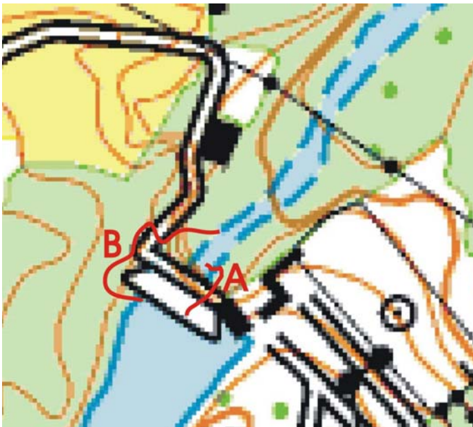
Figur 40. Hjälta kraftverk med de två alternativen för att skapa förutsättningar för fiskvandring förbi kraftverksdammen.
