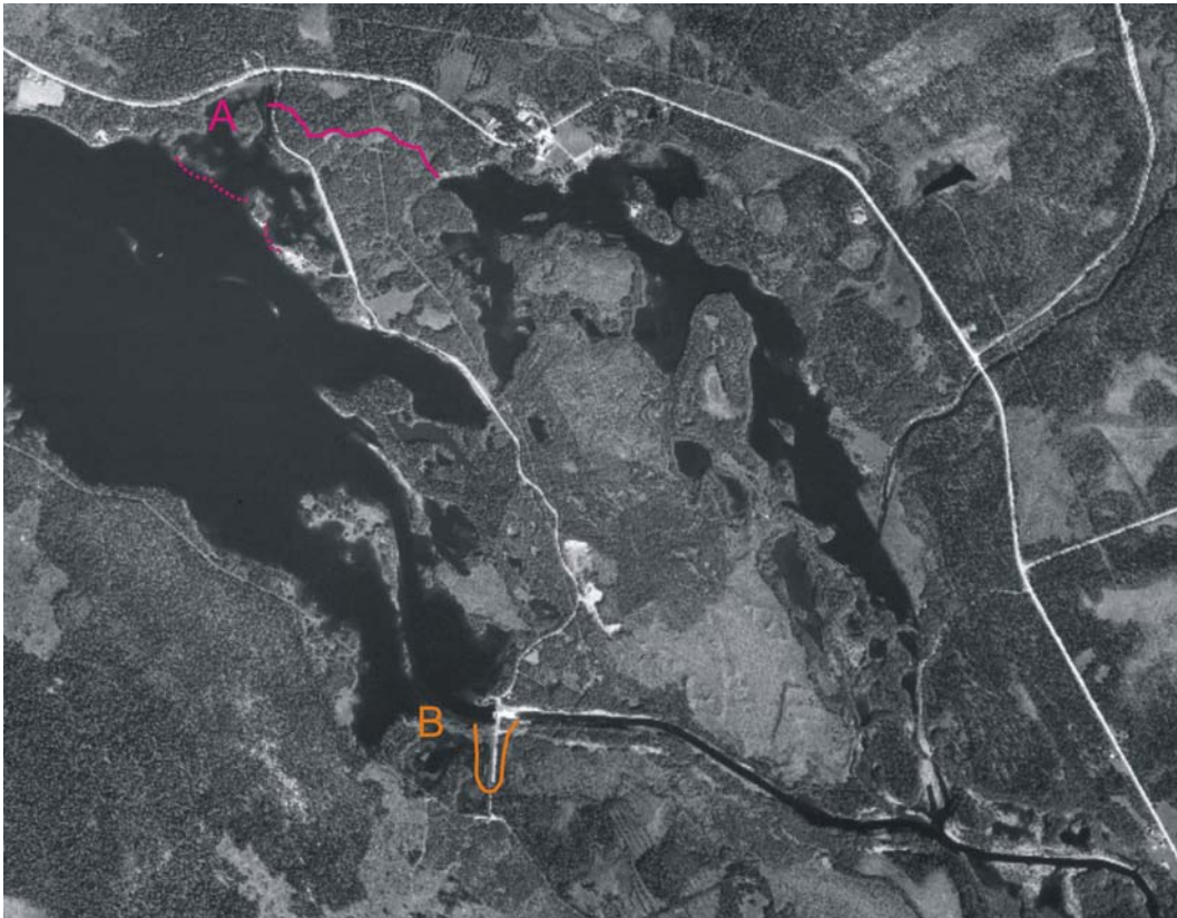
Figur 24. De två förslag till vandringsvägar genom Vojmsjödammen som tillsammans kan skapa både lek- och uppväxtområden (A) och en vandringsväg under isfri period (B). A utgår från att den naturliga bäckens väg utnyttjas till omlöp tillsammans med en refugdamm i Vojmsjön. B utgörs av omlöp från Vojmsjön och den nräna närmast kanalen. För att detta ska få önskad funktion krävs att mätpunkten för minimivattenförling flyttas till dammen i stället för Helitorp så att kanalen alltid för vatten.
